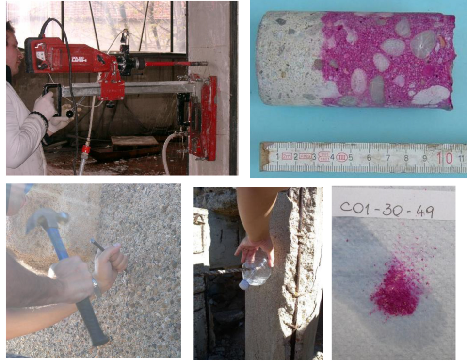
Prelievo di campioni e analisi sul calcestruzzo
