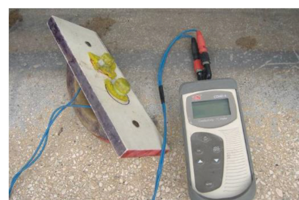
Sonda esterna e conduttimetro per la misura della resistività
