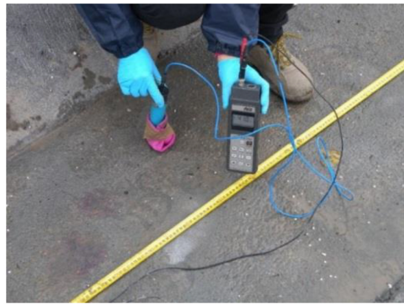
Misura del potenziale con elettrodo CSE esterno
