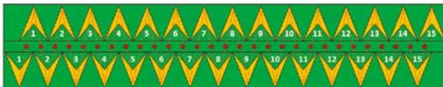
Disposizione degli elementi, canali e pattern di scansione dell'array DX2429.
