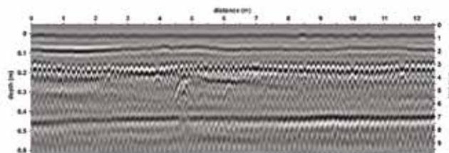
Immagine acquisita su un ponte con array DXG e visualizzata con il software Examiner™. Si notano le interfacce dell'asfalto, del calcestruzzo e le armature.
