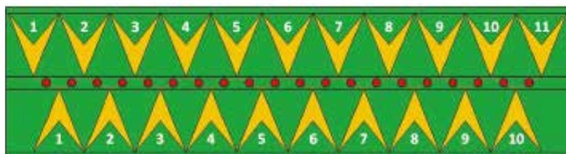
Disposizione degli elementi, canali e pattern di scansione dell'array DXG1820.
