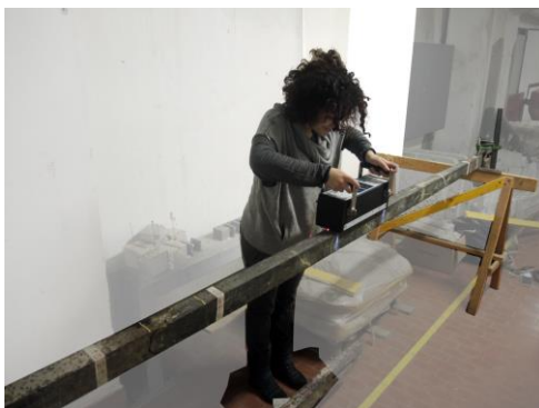
Tomografo a ultrasuoni per indagini su elementi in calcestruzzo e sua applicazione a una catena del Duomo di Milano, con identificazione di un difetto posto a 1 m dallo strumento (~660 \mu s)
