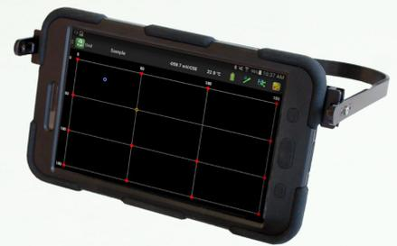
Schermata principale con la visualizzazione grafica dei dati di prova (a seconda del test selezionato)
