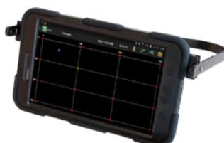
Generazione dei **nodi del reticolo** su cui eseguire le misure del potenziale di corrosione.
